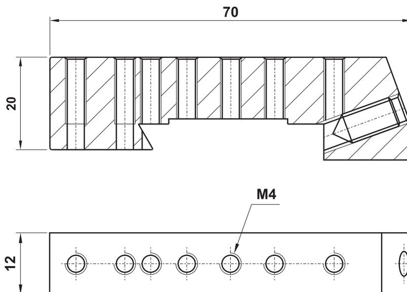
È utilizzabile per l'installazione di una sottobase a posti fissi per valvole della serie 751, 731, 521, 522, 851 su una barra a profilo  $\Omega$  (omega).
