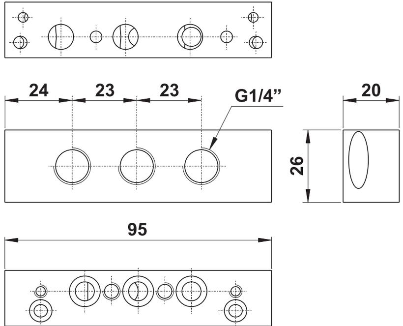
Questa sottobase di riduzione è utilizzata per l'installazione di valvole da 1/8" in una batteria di valvole da 1/4", formando così una batteria ibrida. È dotata di connessioni supplementari G1/4", da tappare in caso di mancato utilizzo. È venduta con i particolari necessari per il montaggio.
