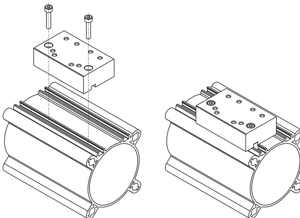
È utilizzabile per l'installazione di una valvola della serie 521 o 522 su un cilindro ISO 15552 dall'alesaggio 32 all'alesaggio 125, PROFILO EASY (serie E).
