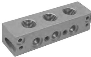
L'intermedio è utilizzabile per dividere una batteria di valvole in due parti e immettere l'aria per l'alimentazione di una delle due attraverso le connessioni di cui è dotato, e/o per dividere in due parti gli scarichi convogliati. È venduto con i pezzi necessari al suo assemblaggio.
